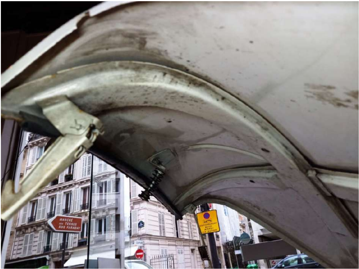
La façade avant a d'ores et déjà été réparée (corrosion de surface décelée)
