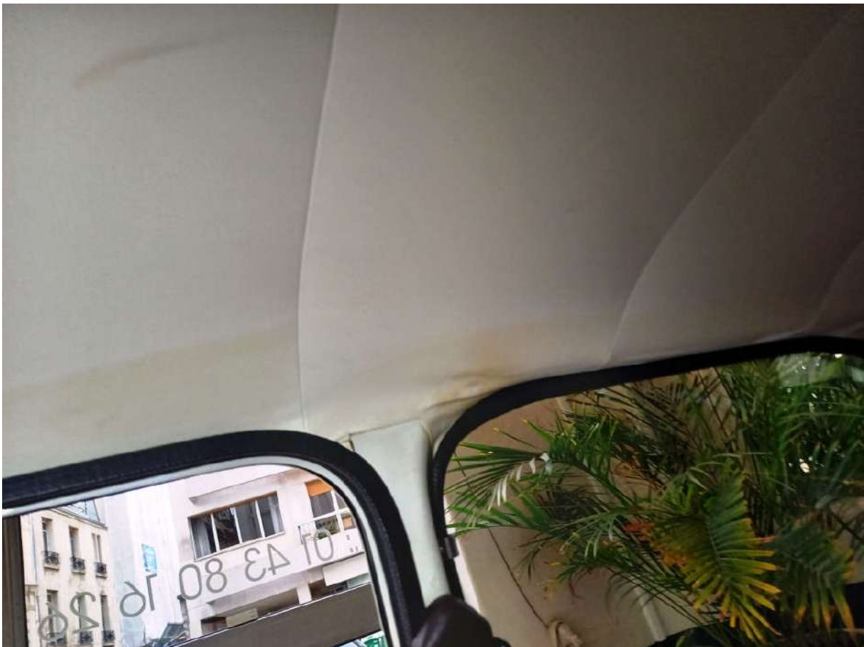
Le ciel de pavillon présente un défaut de positionnement (et quelques taches)
